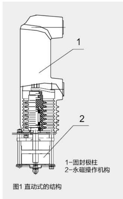
永磁机构采用单稳态单线圈的方式，分闸弹簧内置，结构简单，零件少，免维护，寿命长，动作稳定性好，响应时间快，整体性能优异。
